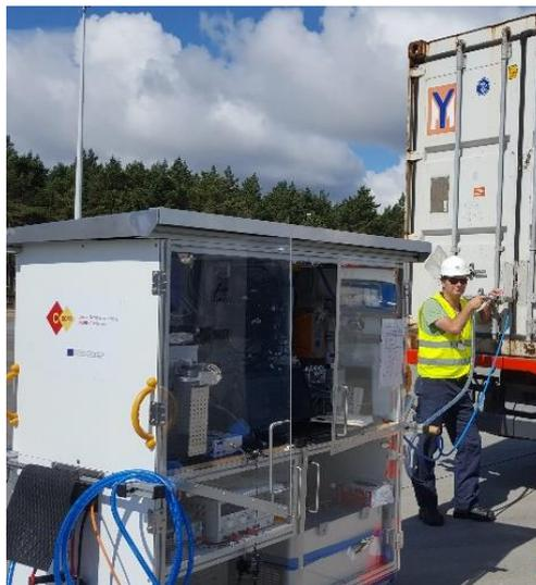
**Abbildung 2:** C-BORD Messwagen bei der Luftprobenahme aus einem See-Container (Quelle: H-BRS).
