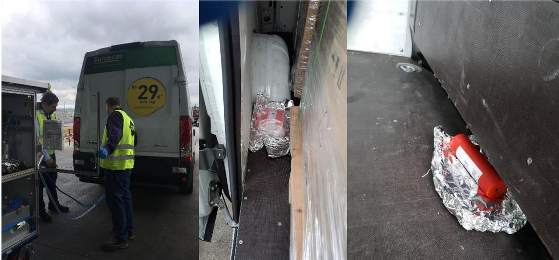
**Abbildung 1:** Links: Testfahrzeug bei laufender Luftprobenahme; Mitte: 1 kg Semtex 1A eingebracht hinter dem rechten Radkasten des Fahrzeugs zusammen mit Beiladung auf Paletten; rechts: TNT-Boosterladung (480 g) eingebracht an der Wand zur Fahrerkabine ohne zusätzliche Beiladung (Quelle: HBR).
