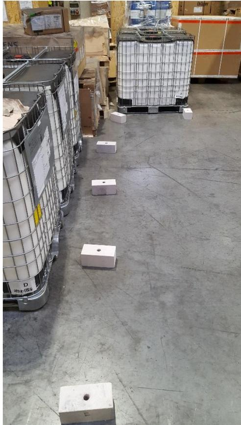
**Abbildung 3: Differenzierungsstrecke aus Kalksandsteinen. Die zu bewertenden Proben befinden sich im Loch in der Mitte der Steine (Quelle: HBRs).**
